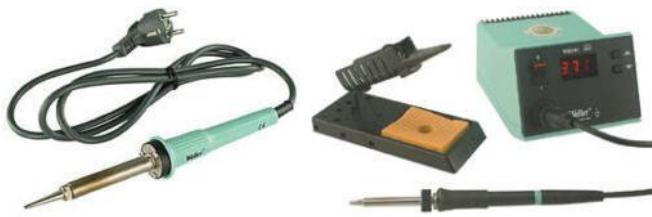
La panne du fer à souder est une sorte de pointe dont une extrémité est maintenue contre la résistance chauffante et dont l'autre extrémité est taillée selon le type de travail plus ou moins fin à effectuer. Il existe de nombreuses formes de pannes en pointe, en biseau, plate, simple ou double.
