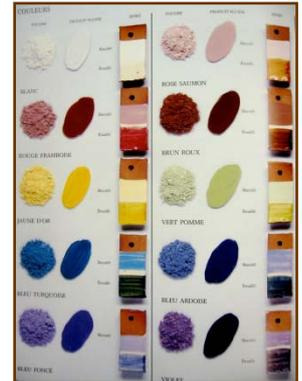
Préparation : environ 100 GR d'engobe pour 1dl d'eau.
