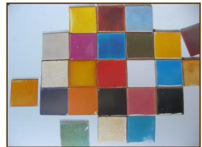
Ces émaux se présentent sous forme de poudre. Il suffit d'y ajouter une quantité d'eau égale à 40 à 50 % du poids sec (voir indication sur la boîte). Il faut ensuite bien homogénéiser le mélange pour obtenir un produit fluide, facile à appliquer. Un émail appliqué en couche trop épaisse peut couler, se fendiller ou s'écailler. En couche trop fine, il ne vitrifiera pas. Épaisseur adéquate : 1 à 1,2 mm : cela vient avec l'expérience et la connaissance de l'émail.
