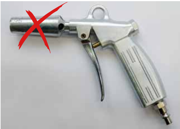
Fig. 2: les pistolets de soufflage avec tubes de Venturi ne sont pas admis.
